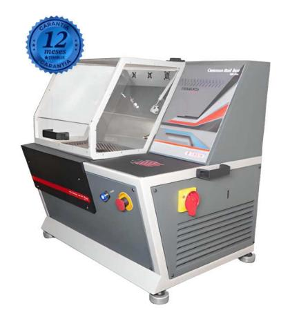
Alimentación: 380V-50Hz/3Ph Capacidad del tanque: 5,5 litros Fluido de prueba: ISO 4113
