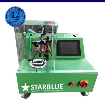
Banco para testear inyectores Diesel Alimentación 380 Volt 50 Hz 3Ph Peso 120 Kg
