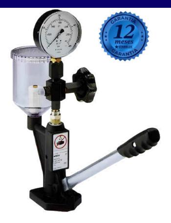
EFEP 60 H es un equipo diseñado para realizar pruebas de presión con una capacidad de hasta 40 Mpa. Es adecuado para la verificación de inyectores de tamaño P, R, S y T.
