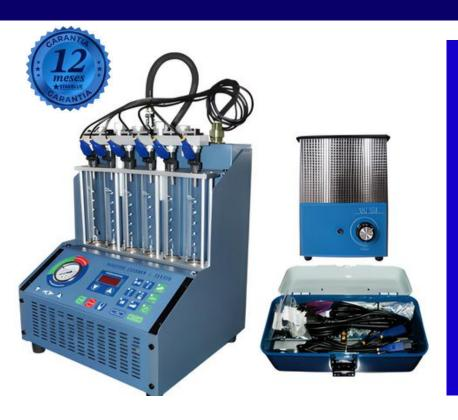
Banco para testear simultáneamente 6 inyectores bencineros
