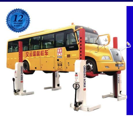
Capacidad de levante: 7.5 ton x columnas Máx distancia entre columnas: 9000mm
