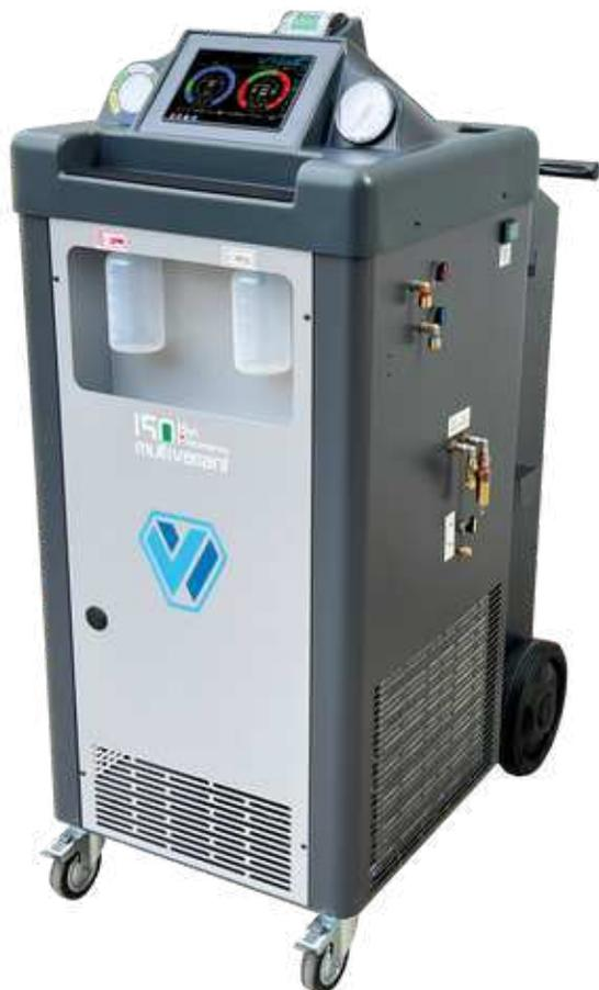
Equipo automático de recuperación, reciclaje, vacío y carga con pantalla táctil 7" en español con impresora
